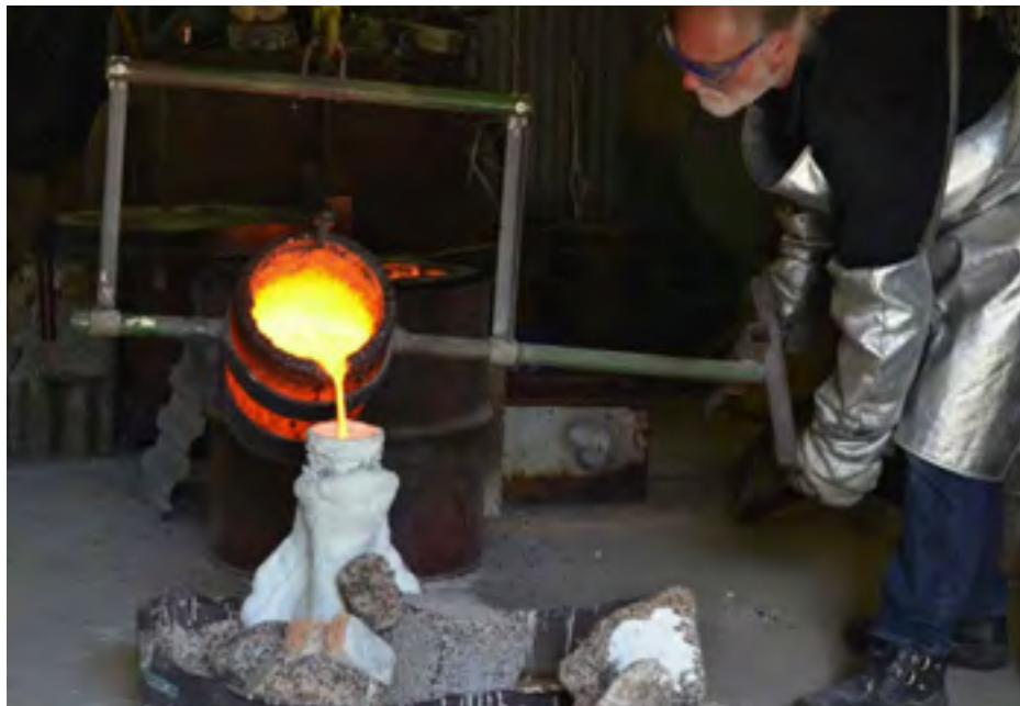
Björn i färd med gjutning av en skulptur. Det smälta bronset håller en temperatur av 1200 C°. Foto Douglas Rydström
