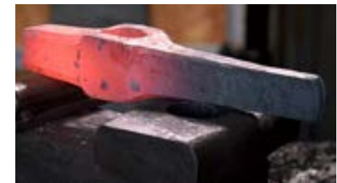
En långnosig skärmejsel på städet, ett bland många verktyg som tillverkats i smedjan.
